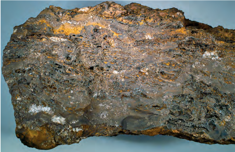
Abb. 5: Brauner, löchrig-zelliger, teils erdiger Goethit mit weißen Baryt-Bruchstücken als Umwandlungsprodukt aus ehemaligem Siderit, angeschliffen, Bildbreite 13 cm. Foto: J. L.
