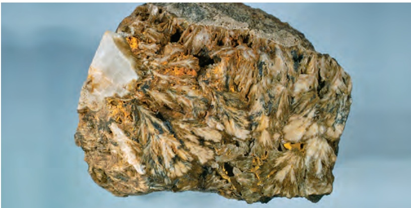
Abb. 10: Fächerförmig angeordnete Baryt-Kristalle mit erdigem Goethit, angeschliffene und polierte Probe, Bildbreite 6 cm. Foto: J. L.
